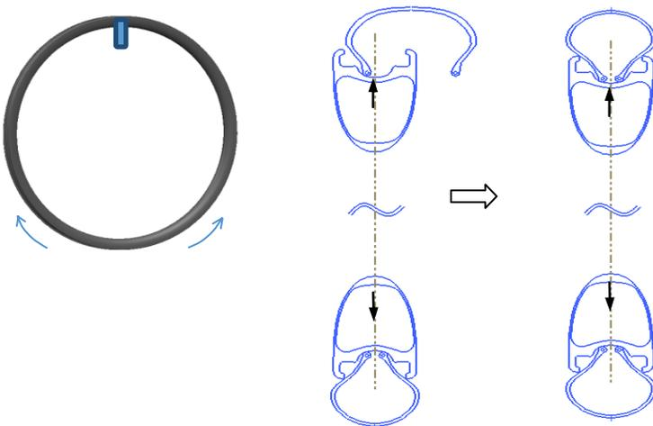
3. Reifen vor der Anwendung des Reifendichtmittels aufpumpen, bis beide Reifenwülste auf der Felge sitzen. **NICHT** den maximalen Luftdruck von Felge oder Reifen überschreiten. Visuell den richtigen Sitz des Reifens auf der Felge sicherstellen (die Sicherheitslinie am Reifen und die Kante der Felge sollten konzentrisch sein).
