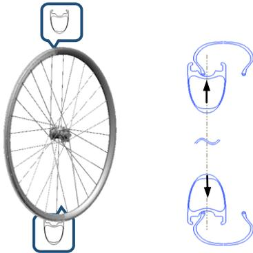
2. Installieren Sie die andere Wulst beginnend bei der gegenüberliegenden Seite des Ventils im mittleren Kanal der Felge; arbeiten Sie sich Richtung Ventil vor.
